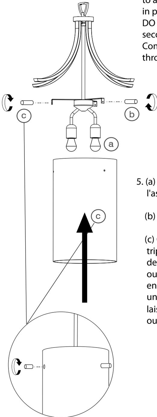
5. (a) Installer les ampoules recommandées avant de continuer l'assemblage.
